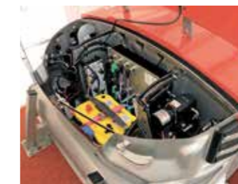
DAS CHASSIS und der Misttank sind aus Edelstahl gefertigt. Bild oben: Eine Gummilippe an der Unterseite des Gerätes sorgt für saubere Arbeit. Bild unten: Bei der Batterie setzt Lely auf einen günstigen Bleiakku. Die Elektronik ist gut geschützt.
