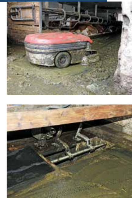
SAUGROBOTER FÜR DEN KUHSTALL: Wagnerbauer Franz Gschaider aus Anthering mit dem Lely Discovery (an der Ladestation). Nach einem halben Jahr fällt die Bilanz positiv aus. Im Bild rechts der Mistabwurfschacht mit Wassertankstelle.
